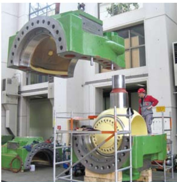
Zusammenbau eines Kugelschiebers
